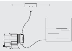
理想安装位置：系统中泵的位置为最佳条件，不易发生气蚀，管路内部产生、积留的气体量较少，不易发生气锁。
